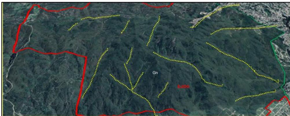
Figura 19. Ambiente de roca gnéisica: fotolineamientos asociados a valles estructurales (amarillo línea punteada).
