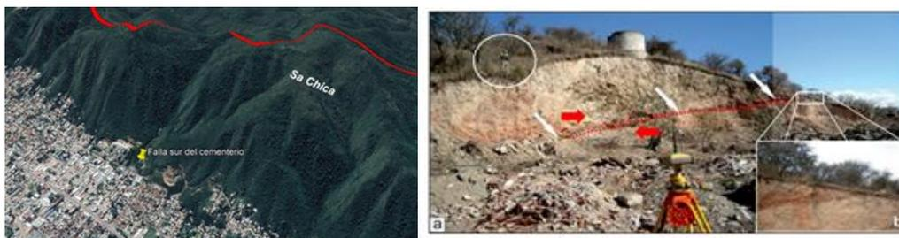
**Figura 26.** Cantera El Tanque. Falla inversa: basamento metamórfico antiguo (techo) cabalga a depósitos modernos (cuaternarios). Fuente: propia y Martino 2012.
