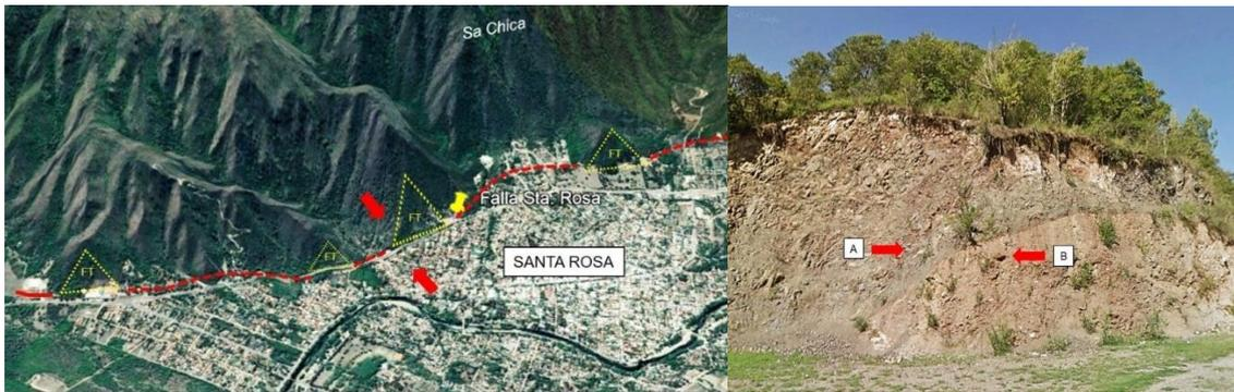
**Figura 25.** Der. (FT) facetas triangulares (indicadoras de neotectónica). Izq. Claro indicio de falla inversa: (A) basamento cristalino montado (más viejo) (B) sobre depósitos detríticos cuaternarios más jóvenes. Fuente: propia.
