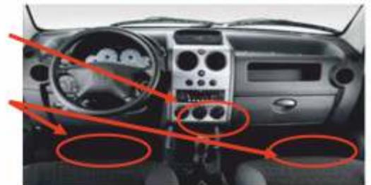
5 - Mantener encendido el vehículo, apagar el aire acondicionado y encender la calefacción al **máximo durante 5 minutos**, con las puertas y cristales cerrados.
