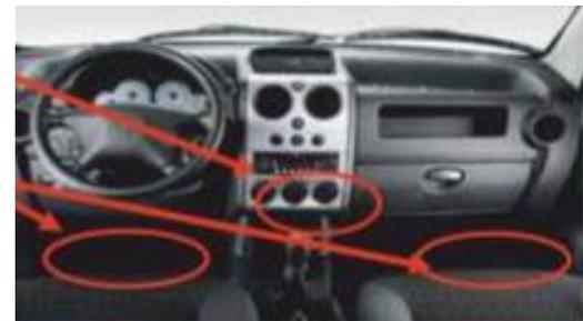
4. Encender el vehículo, luego el sistema de aire acondicionado del vehículo o el sistema de ventilación, en modo circulación y pulverización debajo del tablero/torpedo para que ingresen las microgotas de la preparación y desinfecte el sistema de circulación del aire.
